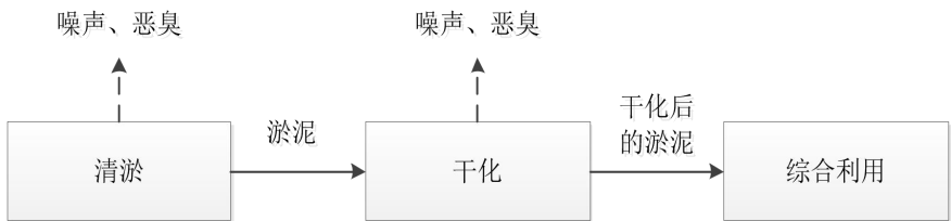
图 2-12 清淤疏通工程施工工艺流程图
